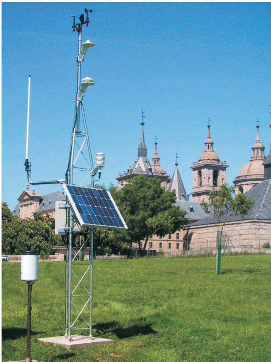
importante del montaje a pie de torre es que es más fácil compartir la toma de tierra con el resto de instrumentación mejorando la protección del sistema completo frente a ruidos y descargas atmosféricas.
